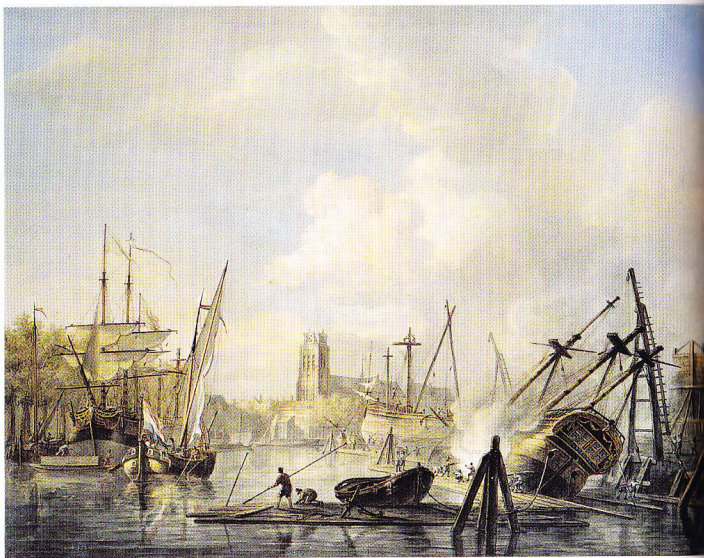
Het schip Dordrecht, dat aan het Achterhakkers met behulp van de kielpaal is gekanteld, wordt in de Kalkhaven bewerkt, 1803. Tekening door M. Schouman, SAD
